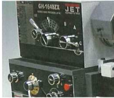
Caja Norton con engranajes templados y rectificadas posibilitan el roscado de numerosos pasos sin cambio de engranajes
