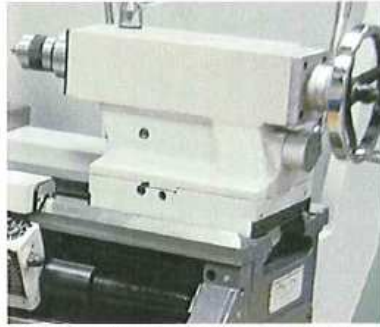
Ajuste del contrapunto para torneado cónico, caña del contrapunto, y volante con escala ajustable
