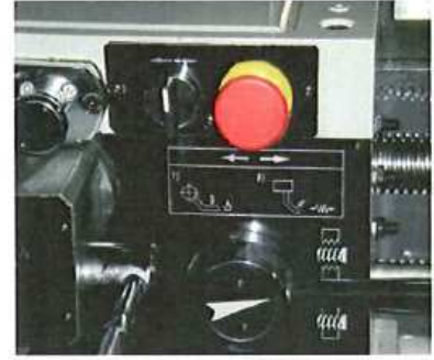
Avanza rápido en el eje Z 5 m/min (GH-2280ZX)
